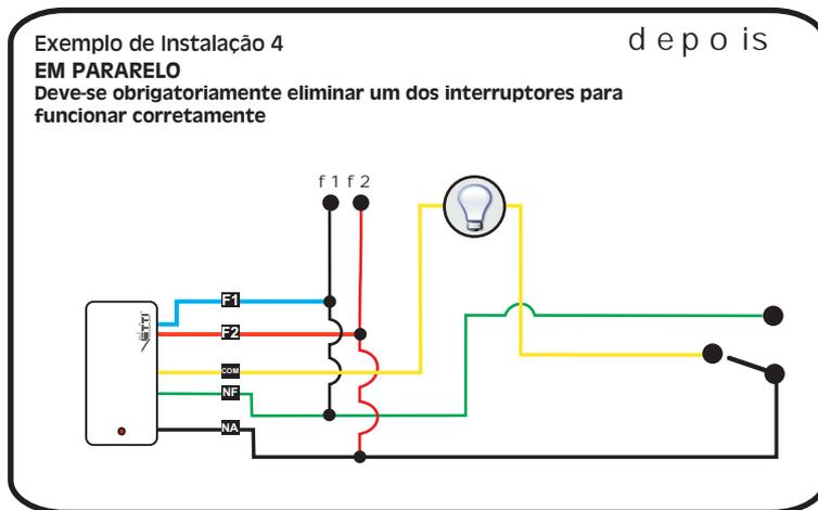
Não exceda a carga máxima permitida pelo receptor arme/desarme (200W em 127V e 400W em 220V) caso necessário utilize um acessório que adapta a um relé de maior amperagem.
