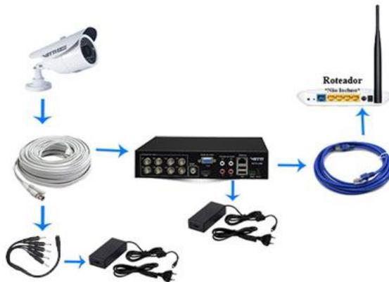
**OBS: Importante proteger todas as conexões do tempo e umidade. Faça a isolamento dos conectores utilizando uma fita adesiva (fita isolante ou fita de alta fusão)**
