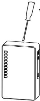
batería de 12V 1.3A al conector NEGRO (Atención no invierta la polaridad). Introduzca un destornillador en el las marcaciones en la parte superior del Panel hacia atrás y la tapa se desprenderá.
