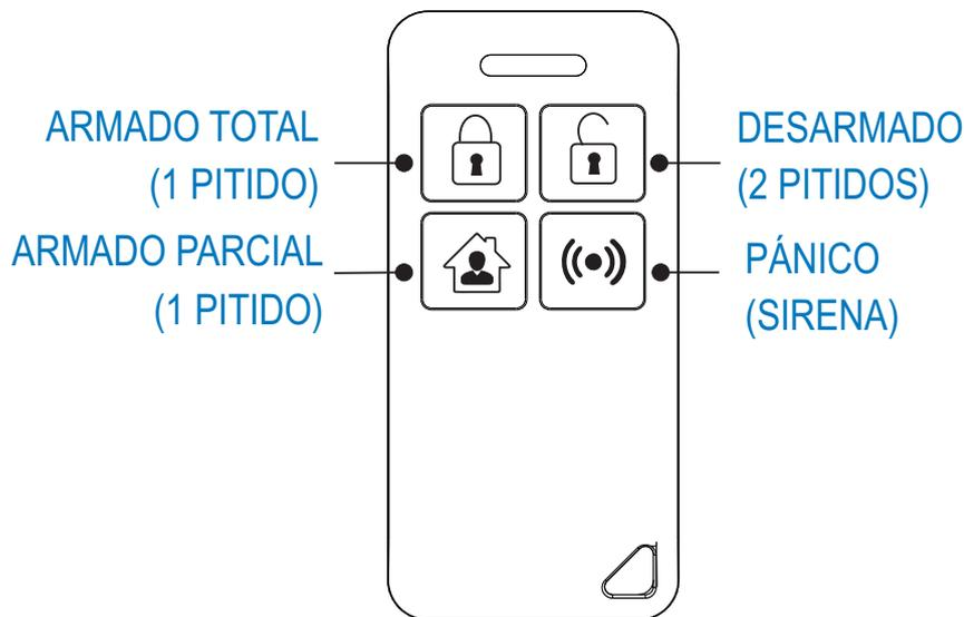
**Armado Total (1 pitido):** Activa todos los sensores cableados que están conectados en el sector 2 (s2).
